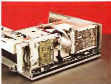
Dettaglio sul montaggio dei dischi espansione verso il frontale al microchip verso il retro il secondo wchester
